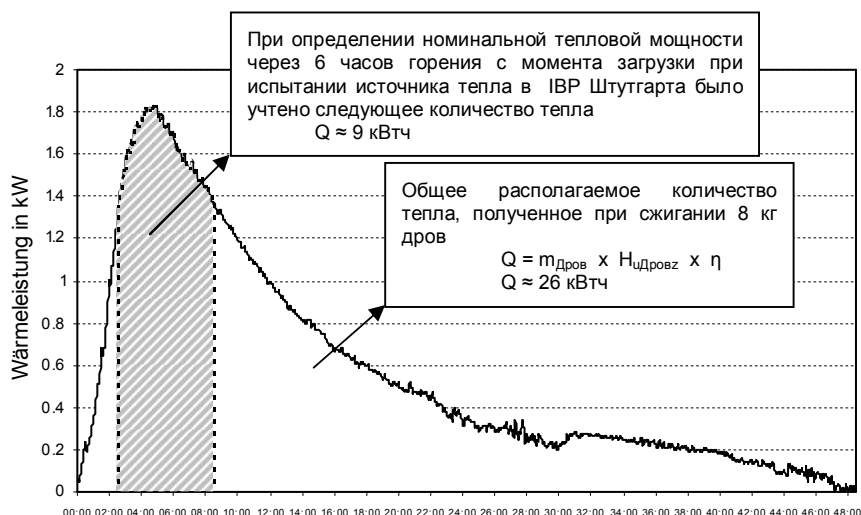
Рис. 6: Теплоотдача малой теплонакопительной печи «Дровушка» с внешней оболочкой толщиной 30 мм из шамота марки НВО+, топливо: дрова, 2 кг (розжиг) + (2 загрузки по x 3 кг)
